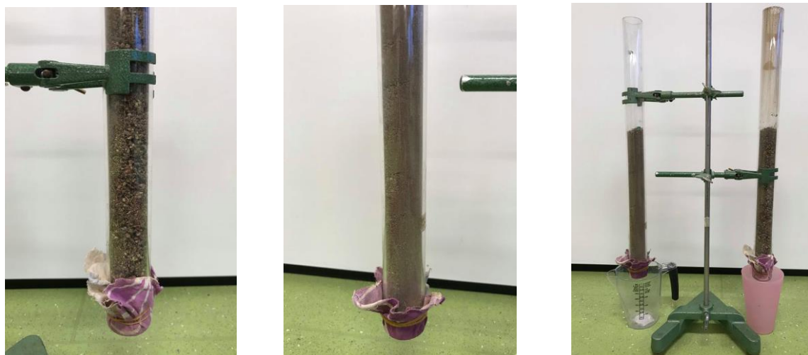
Figur 2: Billeder af forsøgsopstillingen. Fra venstre mod højre: kajakrør med meget store partikler, kajakrør med mindre partikler og den færdige forsøgsopstilling
