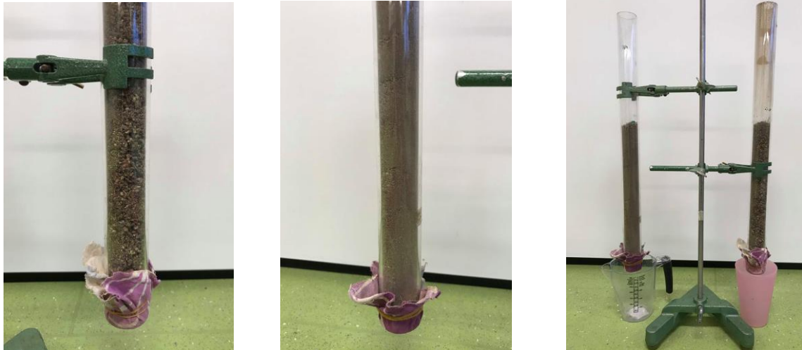
Figur 2: Billeder af forsøgsopstillingen. Fra venstre mod højre: kajakrør med meget store partikler, kajakrør med mindre partikler og den færdige forsøgsopstilling
