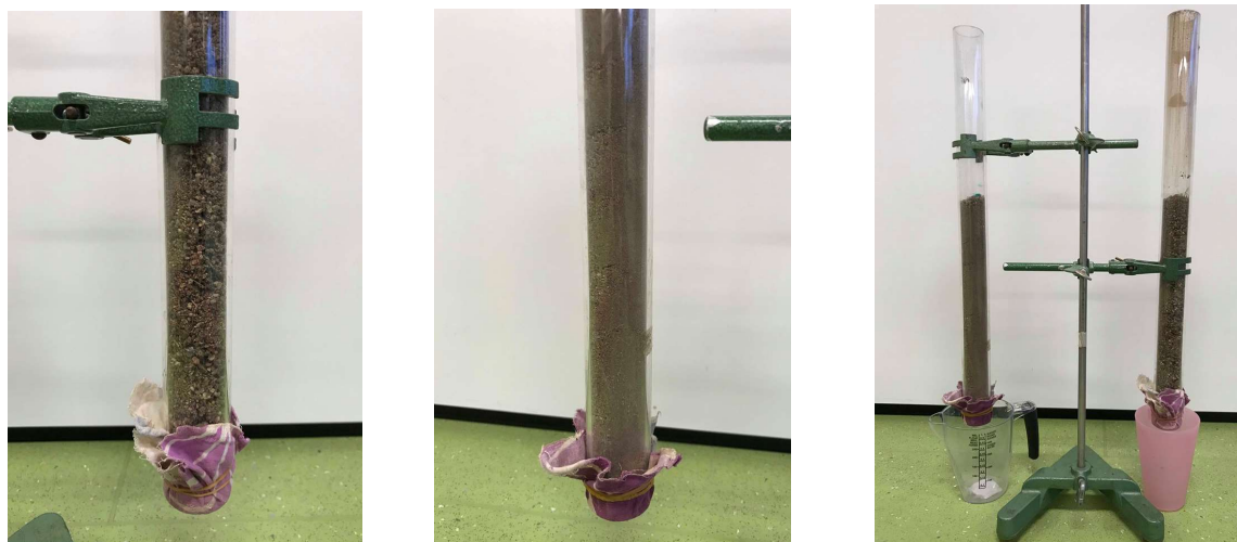
Figur 2: Billeder af forsøgssopstillingen. Fra venstre mod højre: kajakrør med meget store partikler, kajakrør med mindre partikler og den færdige forsøgssopstilling
