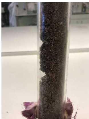
Figur 3: Kajakrør med tydelige luftlommer. Denne søjle er ikke pakket optimalt
