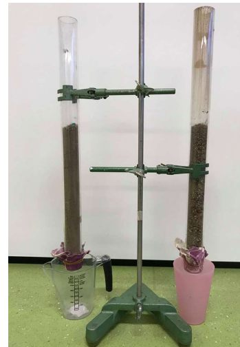
Figur 2: Billeder af forsøgsopstillingen. Fra venstre mod højre: kajakrør med meget store partikler, kajakrør med mindre partikler og den færdige forsøgsopstilling
