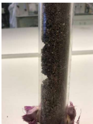
Figur 1: Kajakrør med tydelige luftlommer. Denne søjle er ikke pakket optimalt
