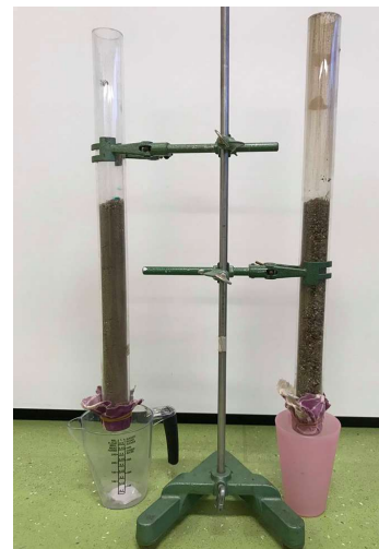
Figur 2: Billeder af forsøgssopstillingen. Fra venstre mod højre: kajakrør med meget store partikler, kajakrør med mindre partikler og den færdige forsøgssopstilling
